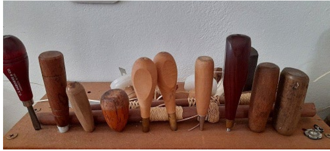
Figura 9. Diferentes tipos de leznas. Fuente: propia, 2021
