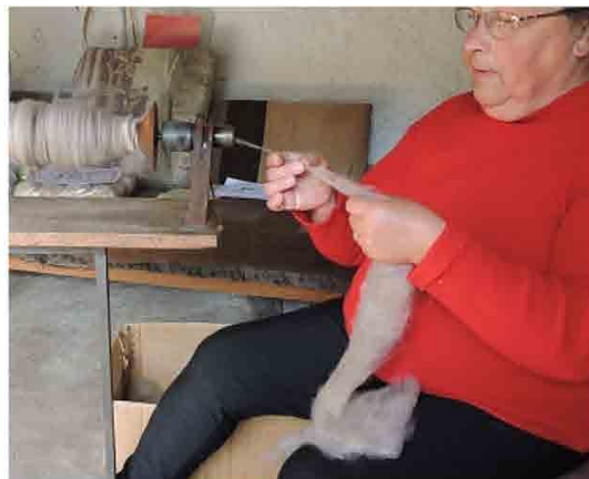
Imagem 9: Fazendo o fio na roca de pedal Autor: Miriel Bilhalva Herrmann - Herval/2019
