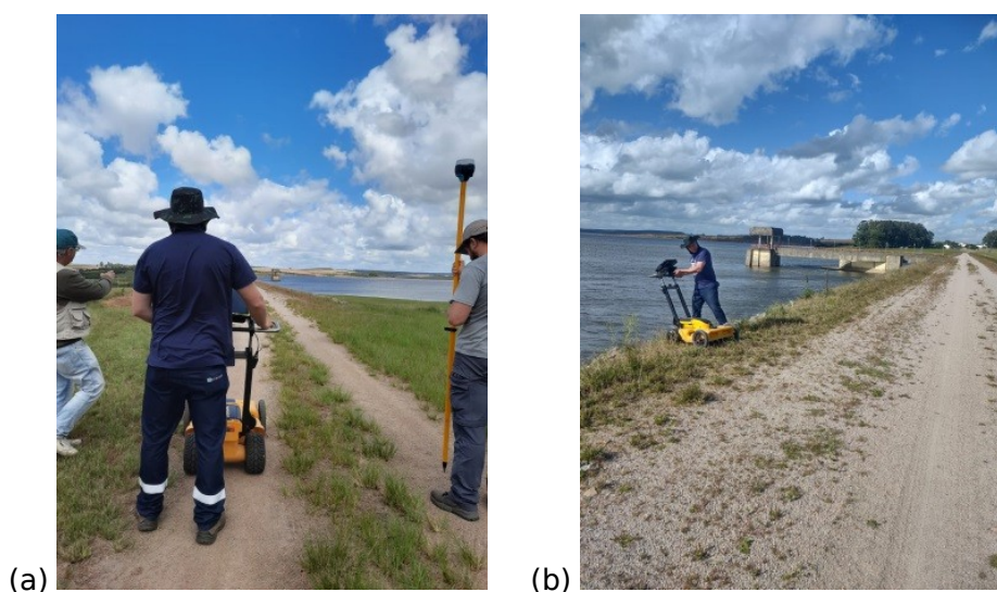
Figura 7 - Caminhamento com o GPR nas direções: (a) longitudinal; e (b) transversal ao barramento.
