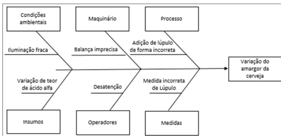
Figura 8 Gráfico Diagrama de Causa e Efeito do amargor da cerveja fase P do ciclo PDCA Fonte: Autores (2020).
